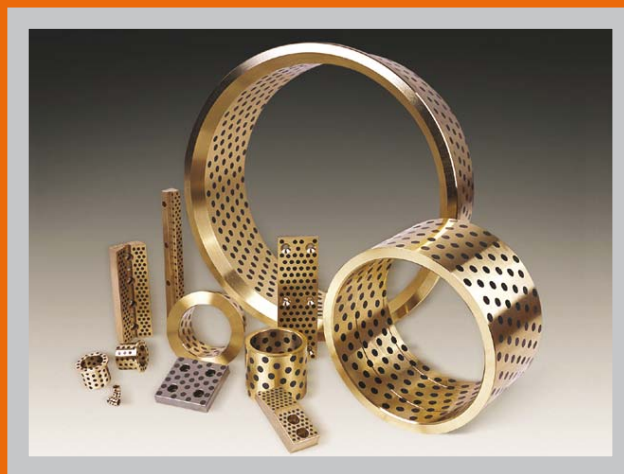
GEDREHTES BRONZEGLEITLAGER , GEFÜLLTE FESTSCHMIERSTOFFDEPOTS, WARTUNGSFREI
